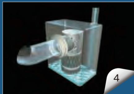
4 汚水吐出後、槽内の水位が下がる事によってモーターは自動停止します。
