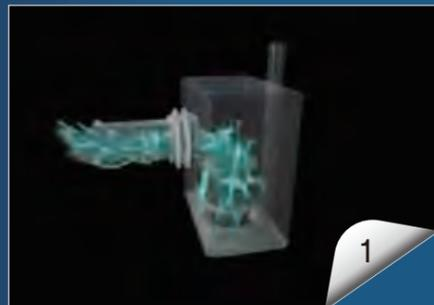
1 トイレの排水が流れ込み、槽内の水位が上昇する事でモーターが起動します。
